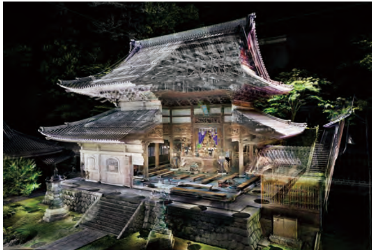
仏殿の点群データ（外観と内部を同時に表示）
